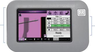
Calculs automatiques - les paramètres de l'aiguille de biopsie sont programmés dans le système pour afficher les marges de sécurité et la distance de l'aiguille en temps réel.
